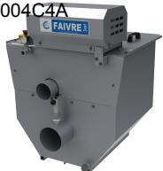
Filtre à tambour sur cuve modèle 4-60 construction en Inox AISI 304L (eau douce). Capacité de filtration 25 l/s à 36 µ avec 10 mg/l de MES. Capacité de filtration 20 l/s à 36 µ avec 25 mg/l de MES. - Moteur tambour 0,25kw 3X400V 50Hz - Tuyau d'entrée et de sortie de cuve **Ø200mm** - Sortie des boues en Ø110mm - Filtre livré avec capot tambour amovible en Inox AISI 304L (Selon plan réf. FT06000A)
